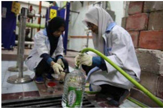
Pensampelan air sistem primer RTP bagi menentukan kepekatan radionuklid dalam bahan penyejuk reaktor (tutup label botol)
