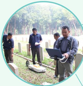
Pengesahan kedudukan mayat di tanah perkuburan menggunakan teknik radar penembusan tanah
