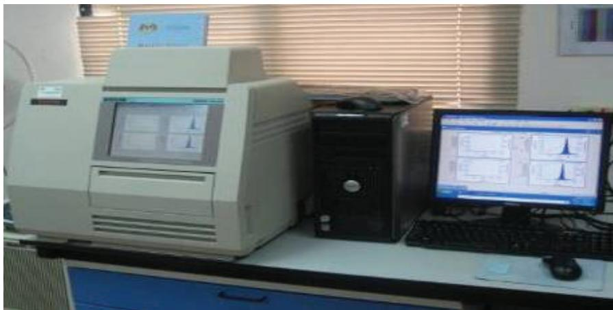
Foto 12.9: Alat pembaca automatik kad TLD yang digunakan bagi mengukur jumlah luminesen dari TLD
