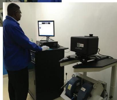
Foto 8.10: Magnetometer Sampel Bergetar (VSM)
