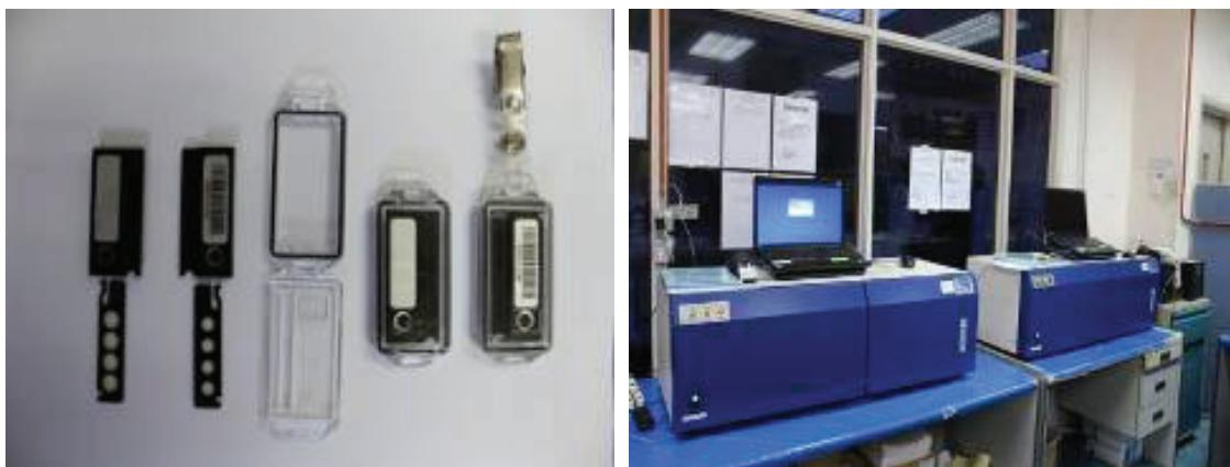
Foto 12.10: OSLD dan alat pembaca automatik OSLD yang digunakan bagi mengukur jumlah luminesen dari OSLD
