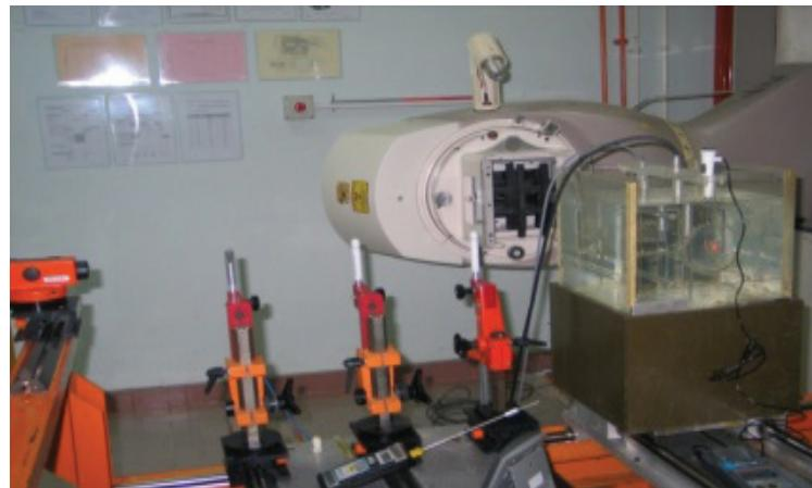
Foto 12.13: Mesin terapi yang digunakan untuk tentukuran kebuk terapi
