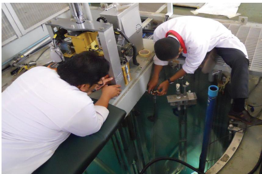
Foto 11.6: Pemeriksaan ke atas Instrumented Fuel Element (IFE) di pelantar reaktor
