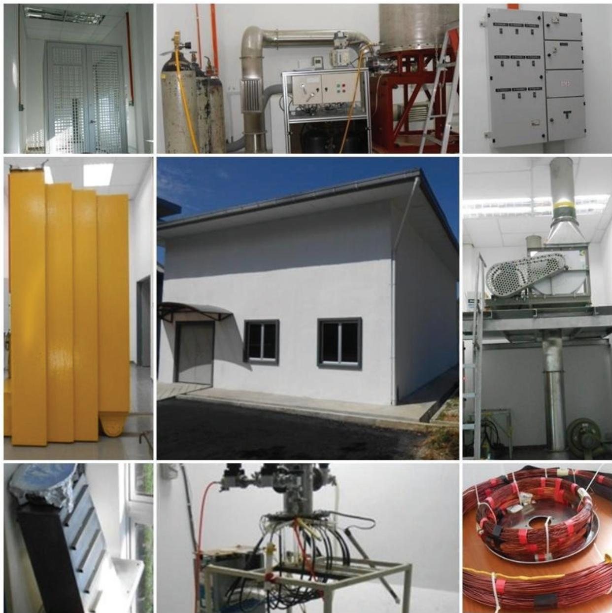
Foto 10.20: Kemudahan dan peralatan yang dibangunkan oleh ADC. Bangunan baru dan bunker untuk mesin babyEBM (tengah), gambar lain bermula dari atas-kiri, mengikut arah jam (sangkar Faraday, sistem gas penebat, panel kawalan elektrik, sistem penyejukan dan penyedut udara, transformator, sistem fokus plasma dan pintu diperbuat daripada plumbum sebagai perisai di pintu masuk bunker).
