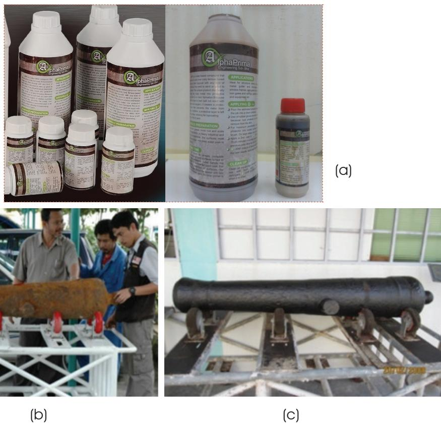
Foto 8.17: (a) Cecair perencat karat, (b) Keadaan meriam sebelum rawatan dan (c) Keadaan meriam setelah rawatan menggunakan perencat karat
