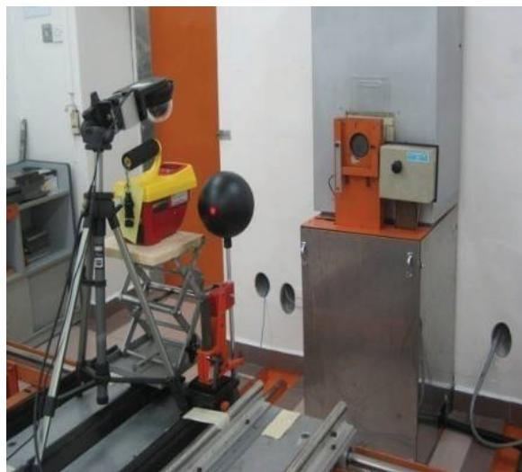
Foto 12.8: Mesin sinar-X bagi tentukuran meter tinjau
