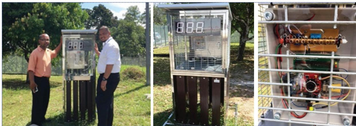
Foto 8.8: SARD diletakkan di lapangan untuk menguji ketahanannya dan kestabilan data sebelum digunakan
