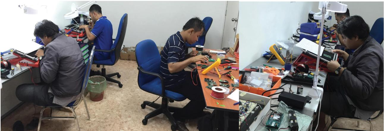
Foto 9.8: Fabrikasi dan pemasangan papan litar tercetak bagi pembangunan Meter Tinjau Pintar
