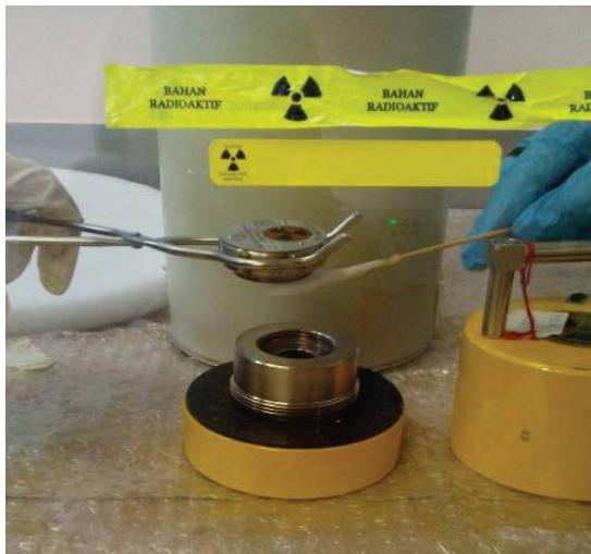
Foto 12.16: Ujian kebocoran punca terkedap sedang dilakukan bagi punca Sr-90
