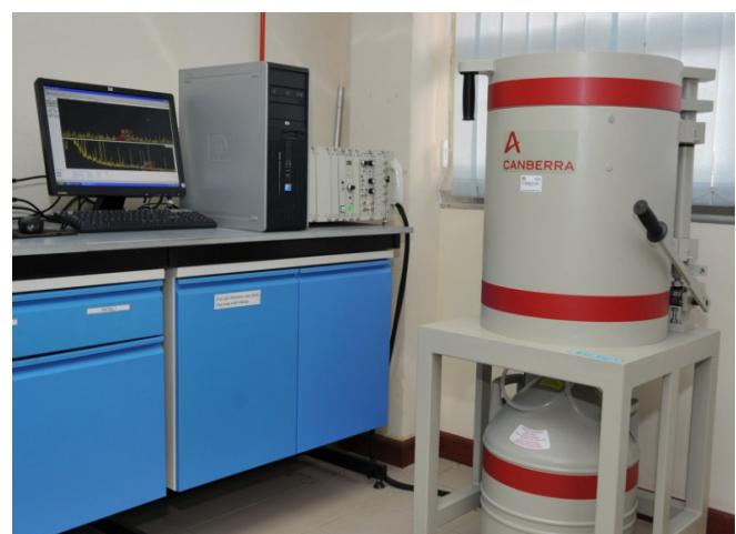
Sistem spektrometer gama digunakan untuk mengukur keaktifan sesuatu radionuklid berdasarkan pada nilai tenaga spesifik yang wujud pada setiap radionuklid pemancar gama. Keamatan sinaran pada nilai tenaga tersebut membolehkan kepekatan keaktifan sesuatu radionuklid dikuantifikasi. Contoh-contoh radionuklid yang dapat diukur menggunakan sistem ini ialah I-131, Cs-134, Cs-137, Ra-226, Ra-228, dan K-40.
