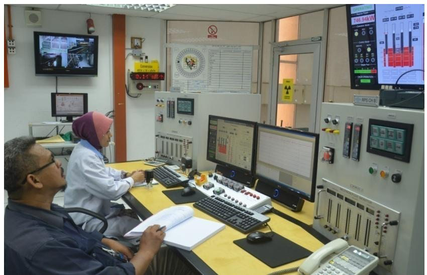
Foto 11.4 Pembangunan makmal instrumentasi dan kawalan reaktor: makmal yang menempatkan konsol analog reaktor yang lama
