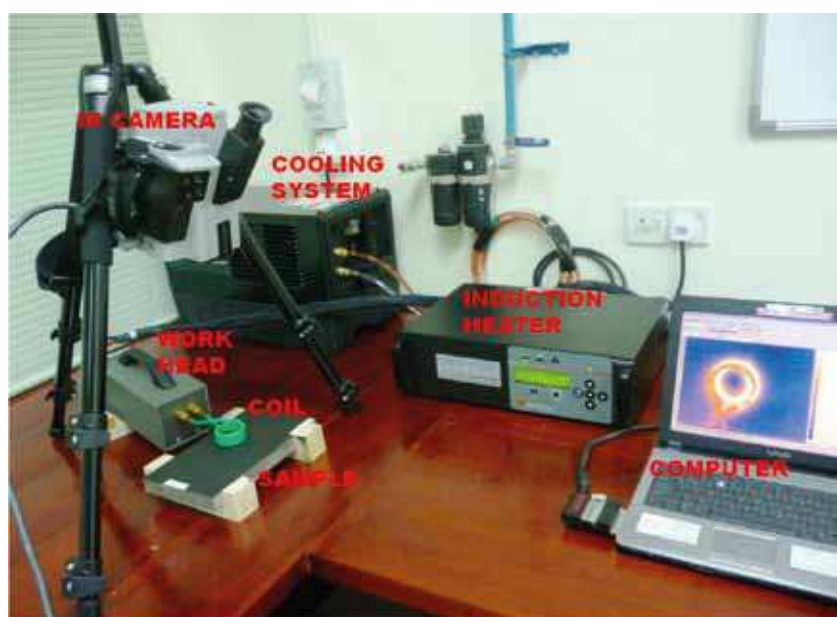
Foto 8.1 Sistem termografi arus pusing yang dibangunkan untuk mengesan kecacatan bahan Photo 8.1 Eddy current thermography system developed to detect material defects
