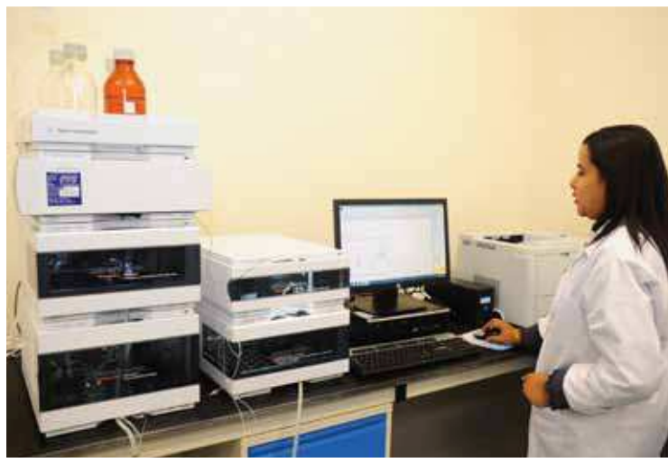
Foto 8.15 Analisis sebatian bioaktif dilakukan dengan Kromatografi Cecair Prestasi Tinggi
