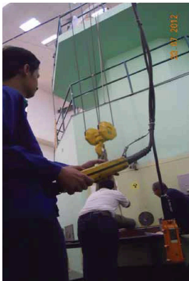
Foto 11.16: Pemetaan taburan fluks neutron di turus terma RTP
