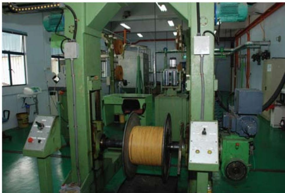
Foto 8.5 Pengumpulan wayar dan kabel yang telah disinar alur elektron.
