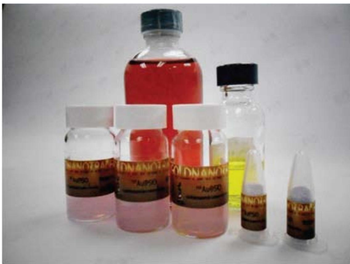
Foto 7.18 Produk Penyurih Emas Nano untuk pengukuran kadar alir bendalir.
