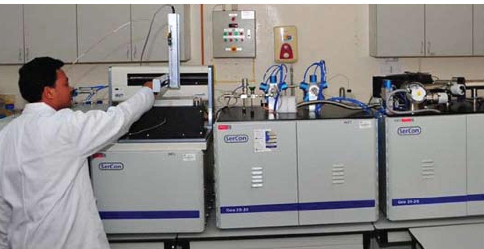
Foto 7.5: Analisis sampel alam sekitar menggunakan IR-MS.
