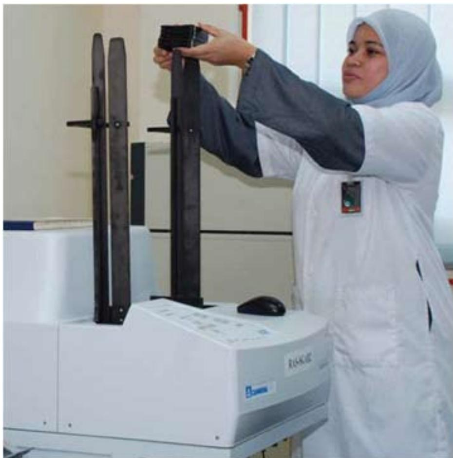
Foto 7.1: Planchet yang mengandungi sampel sedang disusun ke dalam pembawanya untuk ujian pengukuran keaktifan gros  $\alpha/\beta$ .
