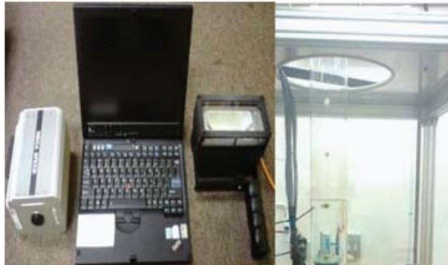
Foto 7.17 Komputer riba dan kamera berkelajuan tinggi yang diguna untuk mengambil imej gelembung dalam turus yang mengandungi cecair.
