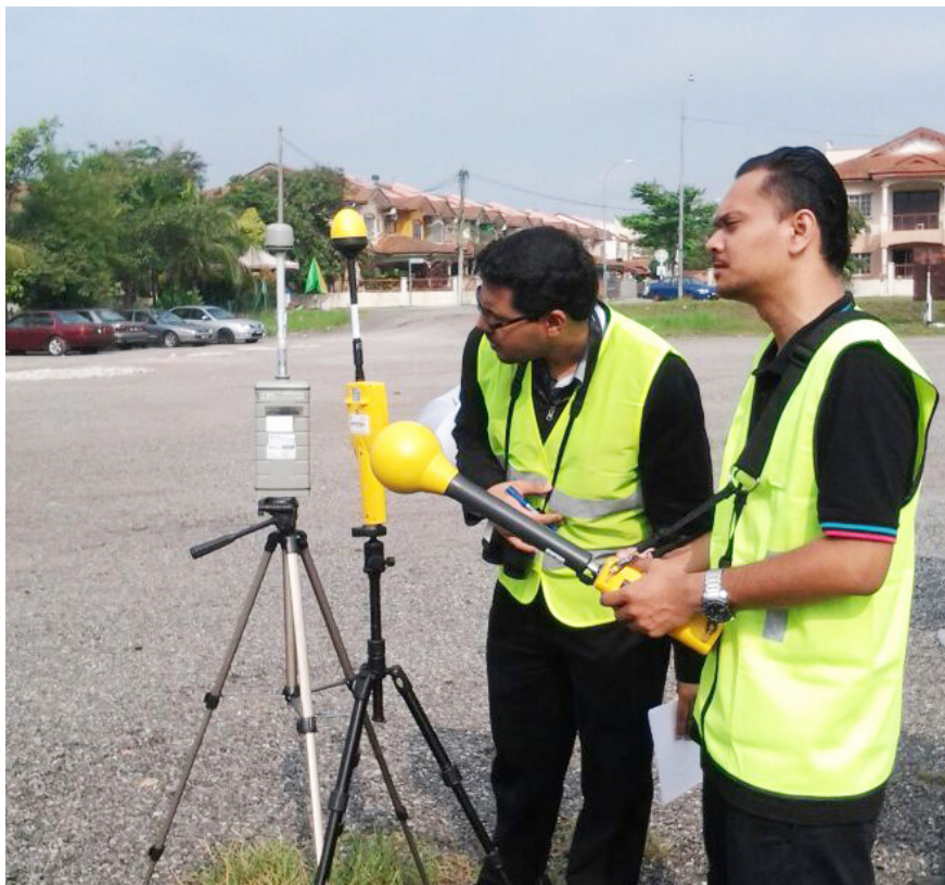
Aktiviti kerja lapangan dan peralatan yang digunakan oleh Kumpulan NIR Nuklear Malaysia untuk mengukur aras bacaan NIR
