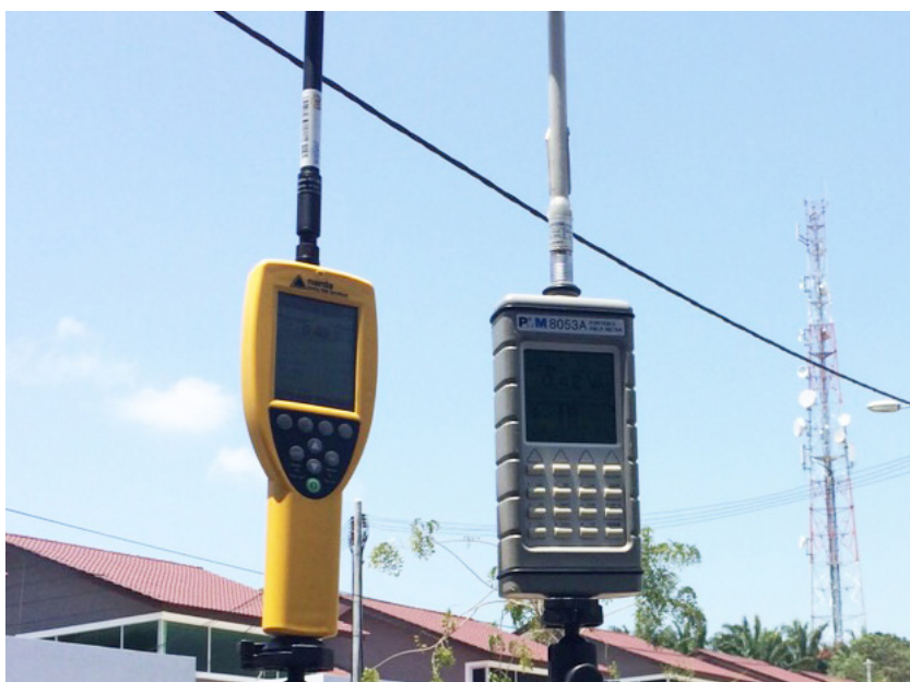
Peralatan yang digunakan oleh Kumpulan NIR Nuklear Malaysia untuk mengukur aras bacaan NIR
