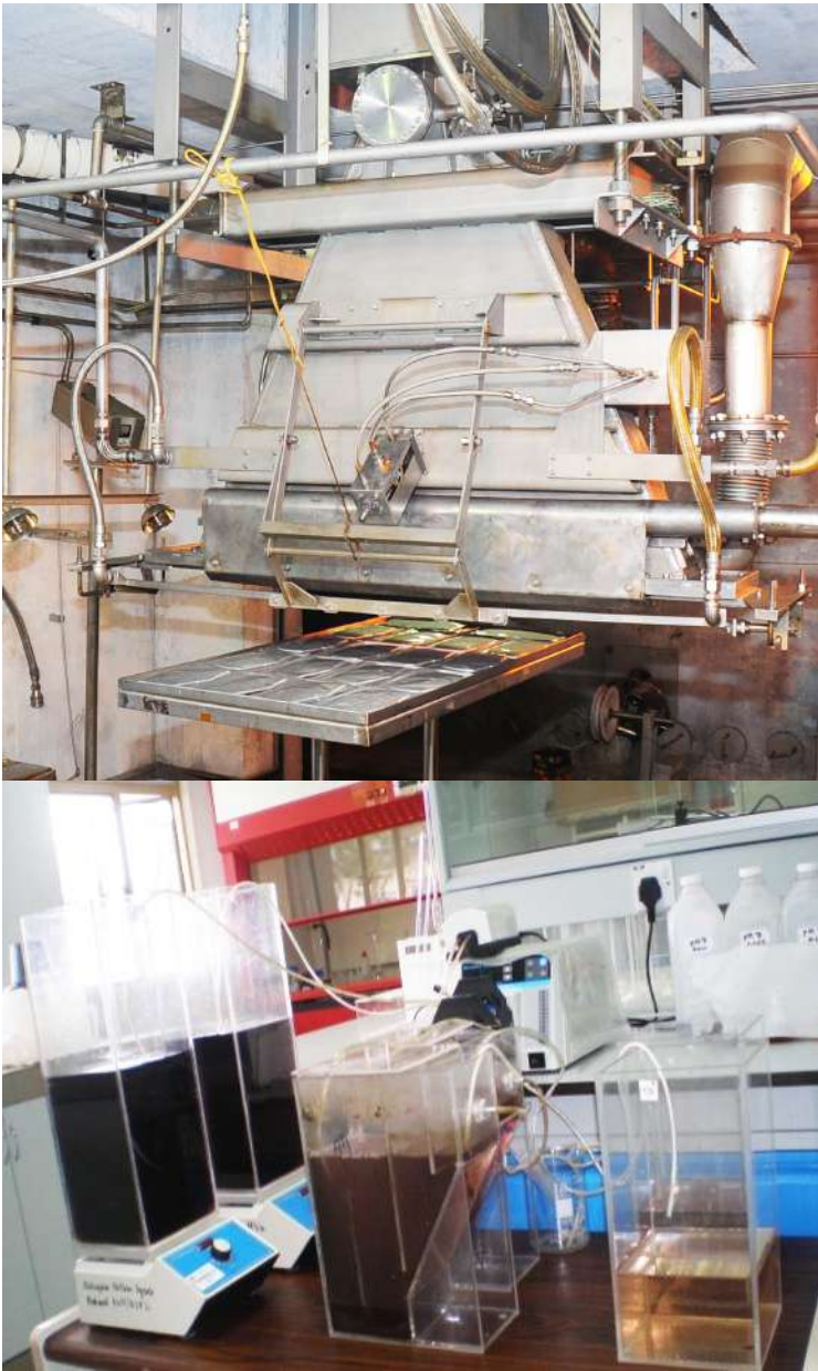
Rajah 2: Mesin pemecut elektron EPS 3 dan set rawatan biologi di makmal
