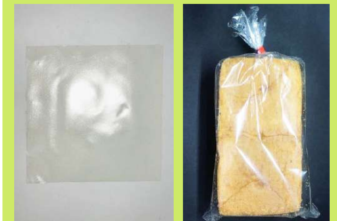
Rajah 8: Prototaip produk bioplastik menggunakan teknologi sinaran alur elektron sebagai pembungkus roti
