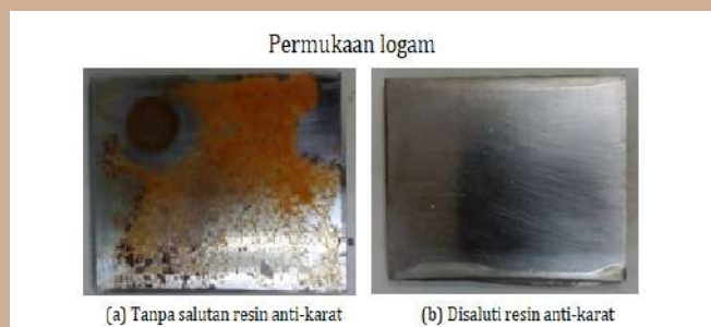
Rajah 2: Ujian antikarat menggunakan resin salutan sawit
