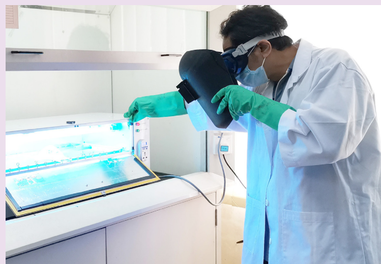
Foto 5: Pemetaan dos sinaran UV menggunakan alat radiometer yang dijalankan oleh penyelidik Nuklear Malaysia
