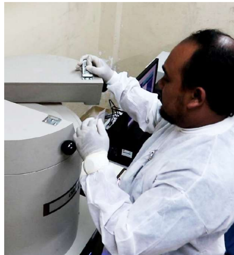
Ujian ketulenan radionuklidik menggunakan spektroskopi gama memastikan radionuklid yang terlibat adalah tulen dan memenuhi spesifikasi
