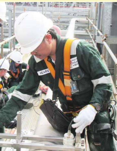
Undukan tolok secara transmisi membolehkan pengukuran isipadu dibuat
