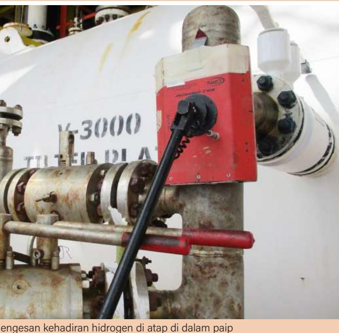
engesan kehadiran hidrogen di atas di dalam paip
