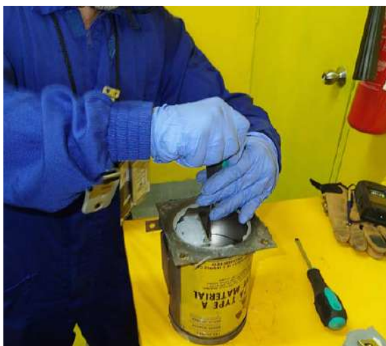
Pembekas DSRS dibuka bagi mengeluarkan punca terkedap
