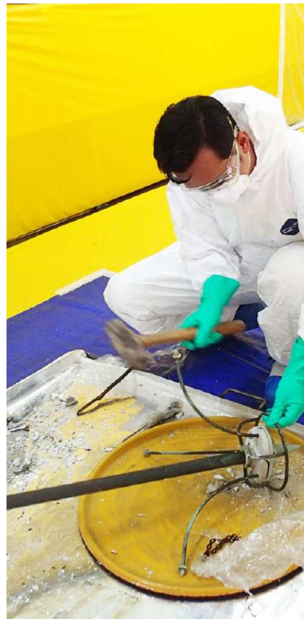
Alat penangkap kilat diceraikan untuk mengeluarkan punca terkedap di dalamnya
