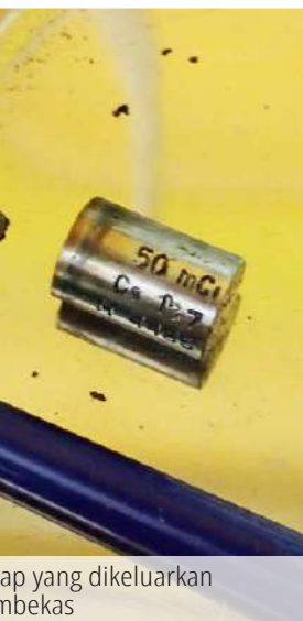
Punca terkedap dikumpulkan di dalam kapsul mengikut jenis radionuklid dan tahap sinaran
