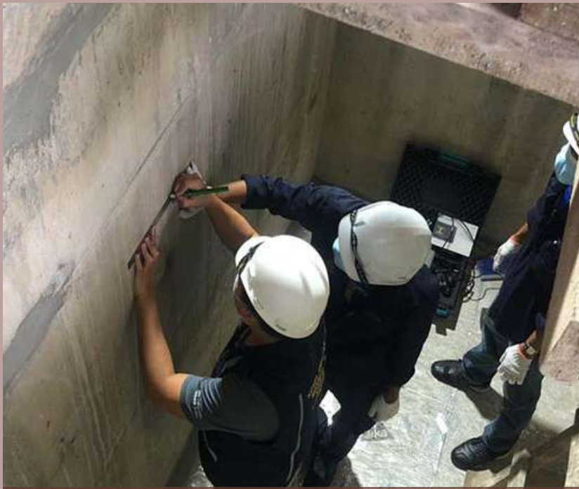
Ujian pengesanan ketebalan dan keberkesanan pemerisaian yang dijalankan di DSRS Interim Storage II menggunakan kaedah ujian tanpa musnah
