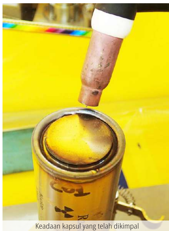
Kapsul dikimpal sebagai sebahagian dari langkah membendung dan mengasing sisa radioaktif yang dilupuskan
