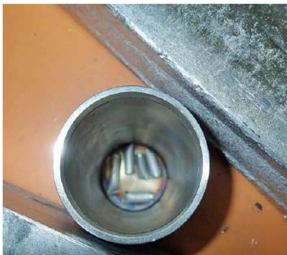
Punca terkedap dikumpulkan di dalam kapsul mengikut jenis radionuklid dan tahap sinaran
