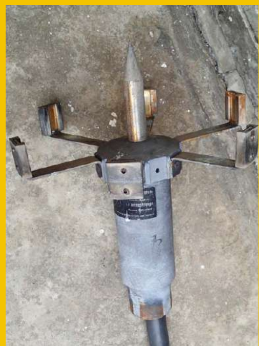
Contoh alat penangkap kilat yang telah ditanggalkan dari bangunan tinggi
