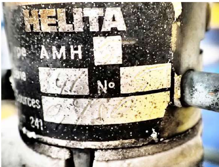
Maklumat yang terdapat pada bahagian badan alat penangkap kilat yang menerangkan jenis radionuklid, tahap aktiviti dan tahun pembuatan. Maklumat-maklumat ini adalah penting untuk kerja pengurusan sisa radioaktif
