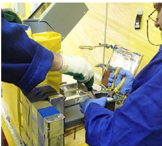
Pengeluaran punca terkedap dilakukan dengan perlindungan oleh bongkah timah bagi mengurangkan dedahan kepada sinaran mengion
