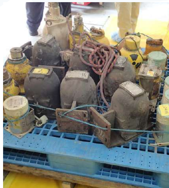
Contoh pembekas yang mengandungi DSRS yang diterima oleh WasTeC bagi kerja-kerja pelupusan
