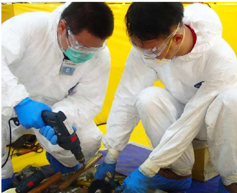
Aplikasi alat penangkap kilat yang terdedah kepada keadaan ekstrim menuntut supaya ia dibina dari bahan tahan lasak bagi melindungi punca radioaktif terkedap di dalamnya. Ini secara tidak langsung merumitkan kerja mengeluarkan punca terkedap ini
