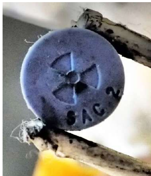
Contoh punca terkedap yang dikeluarkan dari alat penangkap kilat terpakai
