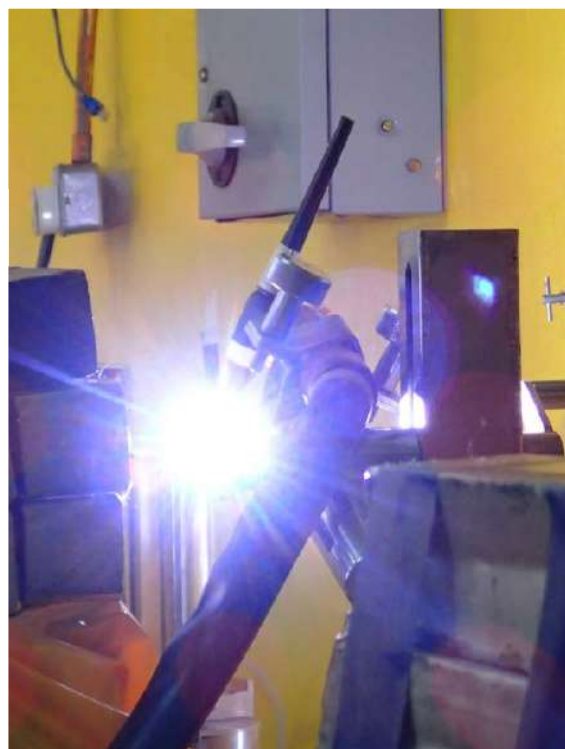
Kapsul dikimpal sebagai sebahagian dari langkah membendung dan mengasing sisa radioaktif yang dilupuskan
