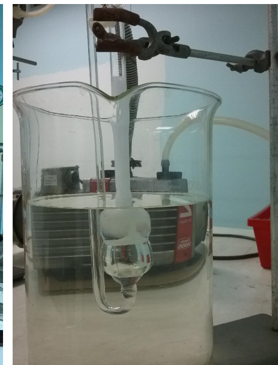
Rajah 7: Proses penyerapan terus gas \text{CO}_2 dengan mengalirkannya melalui campuran cecair penyerap karbon, Carbosorb E dan sintilator Permaflour E+.
