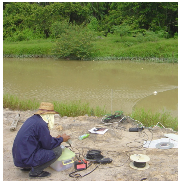
Kajian pergerakan air permukaan menggunakan penyurih radioaktif 99mTc
