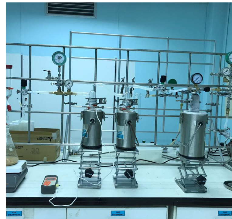
Rajah 6: Sistem pengekstrakan gas \text{CO}_2 bagi kaedah penyerapan terus yang sedang dibangunkan di makmal Kumpulan Aplikasi Penyurih Alam Sekitar (ETAG), Agensi Nuklear Malaysia
