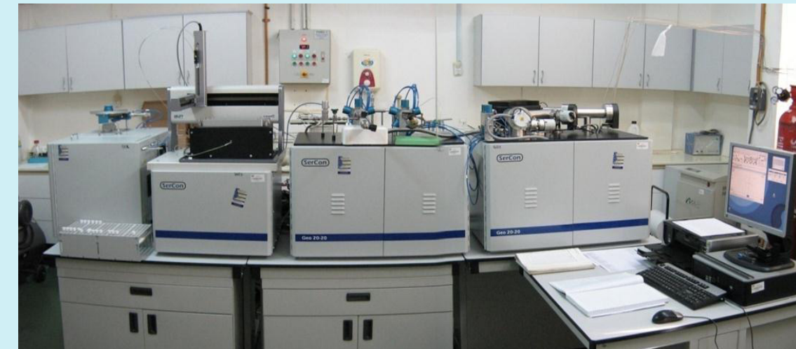
IRMS yang digunakan dalam teknik hidrologi isotop untuk pengukuran isotop sekitaran
