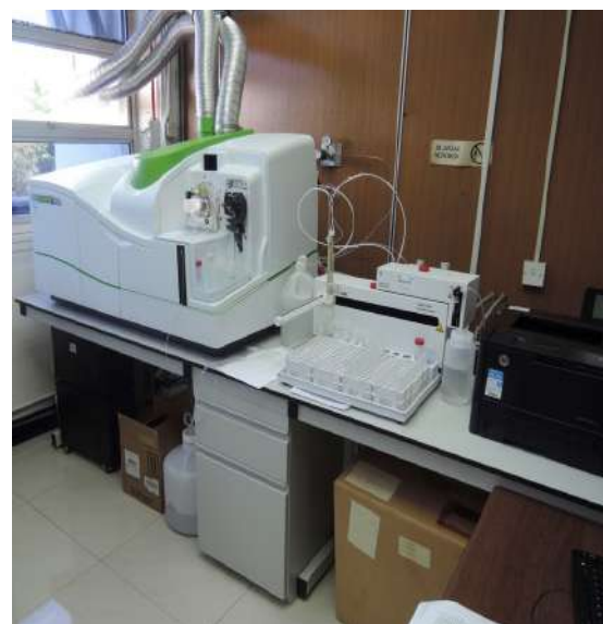
Gambar foto: Alat ICPMS yang digunakan dalam mikroanalisis forensik nuklear
