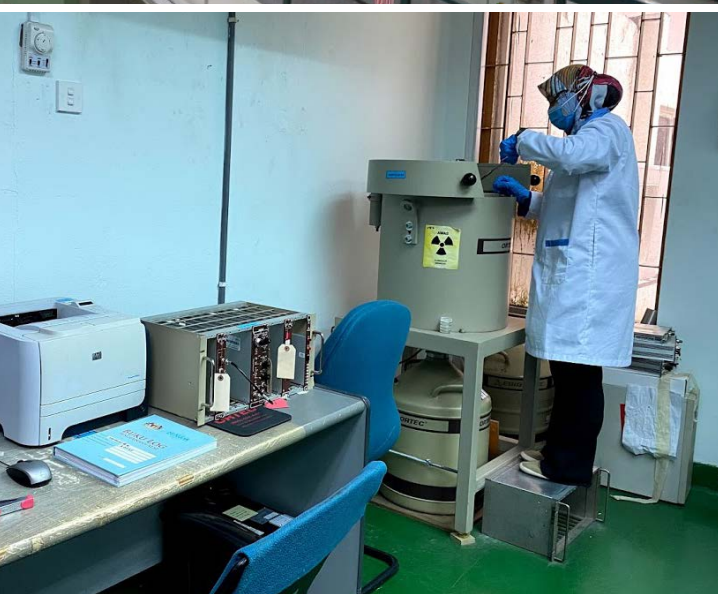
TRIGA PUSPATI dan sistem spektrometri gama bagi teknik Analisis Pengaktifan Neutron (NAA)
