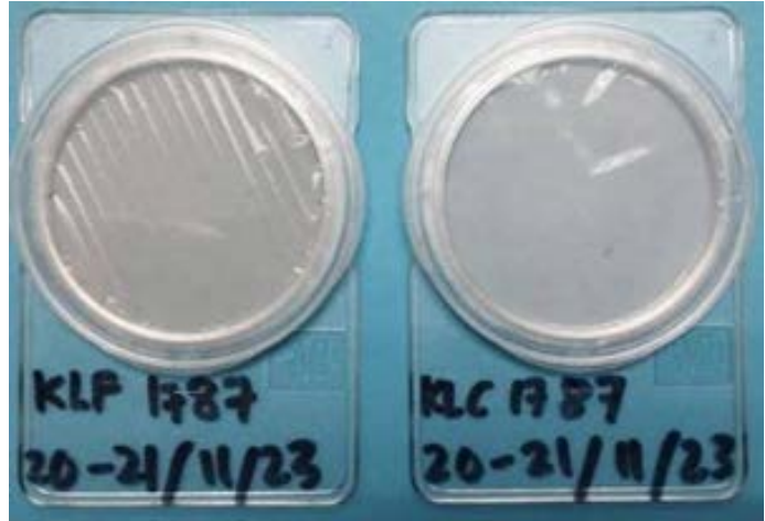
Sampel zarah udara yang diambil dari stesen persampelan di Pusat Bandaraya Kuala Lumpur
