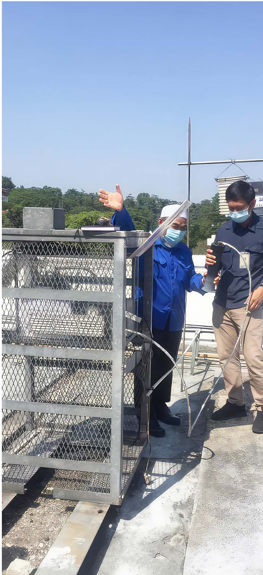
Kakitangan Nuklear Malaysia sedang memasang peralatan persampelan zarah udara
