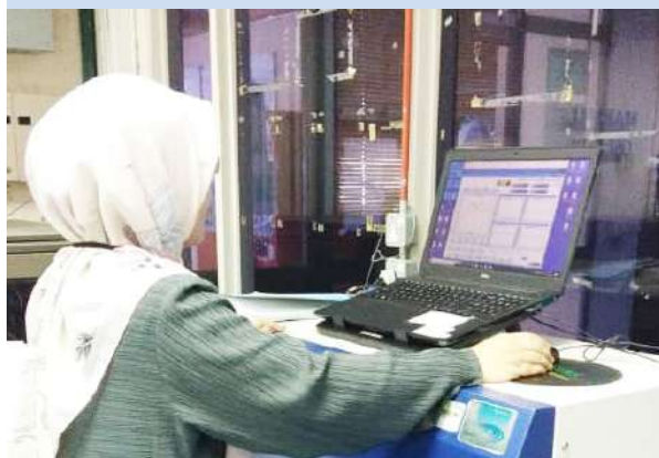
Pembacaan Lencana OSL menggunakan Mesin Pembaca OSL Jenis A200
