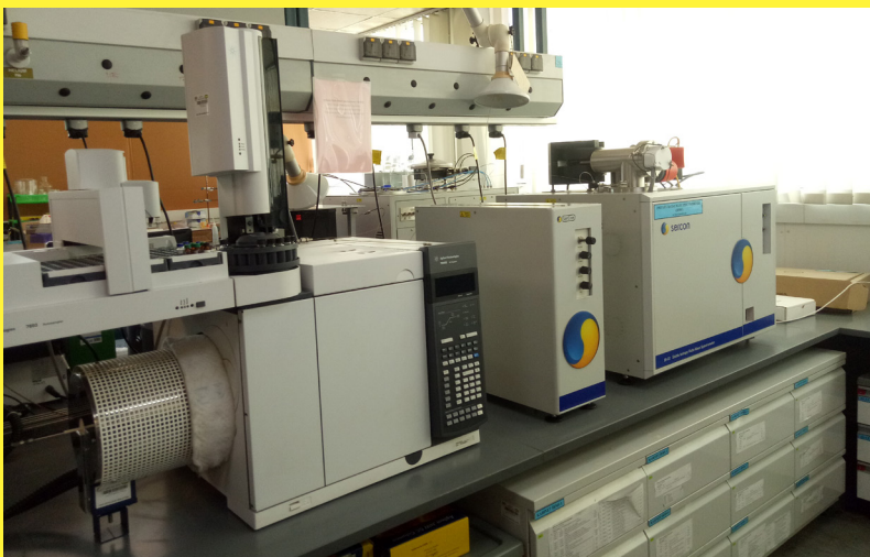
Rajah 3: Analisis isotop stabil menggunakan Isotope Ratio Mass Spectrometer
