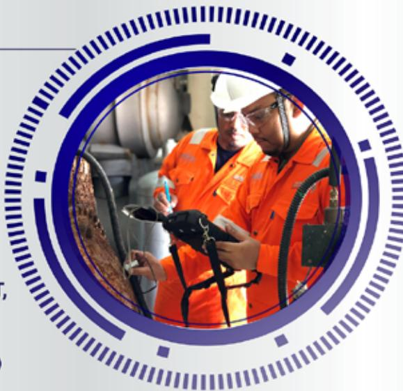
Kumpulan LENDT menawarkan khidmat dan kemudahan Ujian Tanpa Musnah (NDT) Termaju untuk menilai integriti dan kualiti bahan, komponen atau struktur. Antara teknologi yang digunakan ialah *Radiographic Testing - Digital* (RT-D), *Phased Array Ultrasonic Testing* (PAUT) dan *Infrared Thermography Testing* (IRT).
