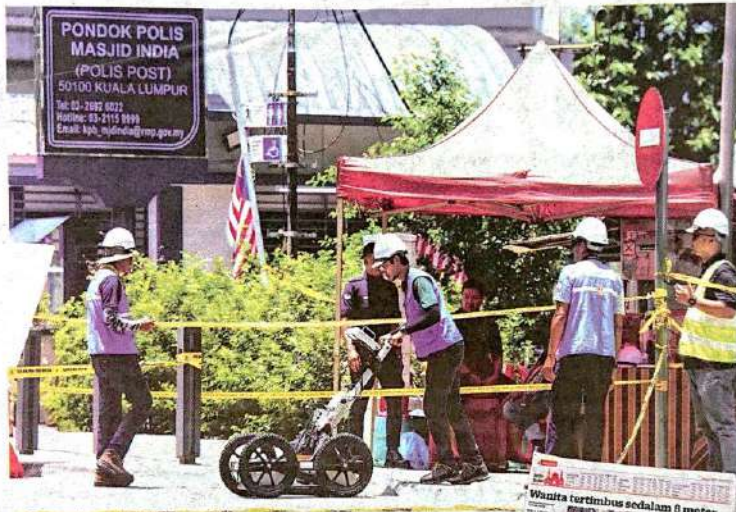
KAKITANGAN Jabatan Mineral dan Geosains Malaysia menggunakan alat GPR dalam operasi SAR mangsa tertimbus semalam.
