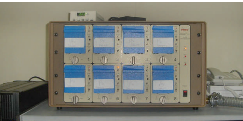
Sistem Spektrometri Alfa dan Pengesan Alpha Passived Implanted Planar Silicon (PIPS)
